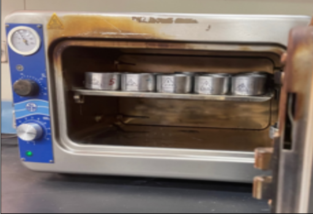
الشكل (7): الفرن المستعمل في تقدير المحتوى الرطوبي لعينات خبز القوالب.
