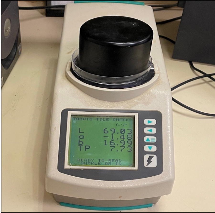
الشكل (6): جهاز تقدير اللون لعينات الخبز المحتوي على نسب من الكيتوزان الفطري.
